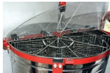
Geöffneter Deckel der Schleuder
