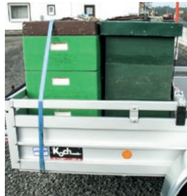
Ladungssicherung am PKW-Anhänger durch Zurrgurten und Klemmbrett
