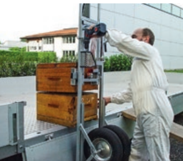
Sackkarre mit Hebefunktion Quelle: www.apilift.de
