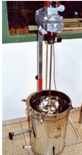
Rührwerk mit höhenverstellbarem Stativ
