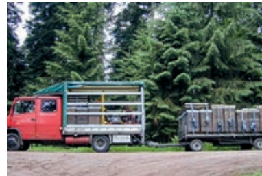
Sicherung von Magazinbeuten durch Niederzurren mit Spanngurten (Zurrgurten)
