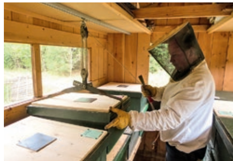
Flaschenzug mit Schienensystem im Deckenbereich des Bienenhauses
