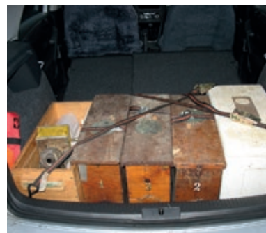
Ladungssicherung im PKW mittels Zurrgurten
