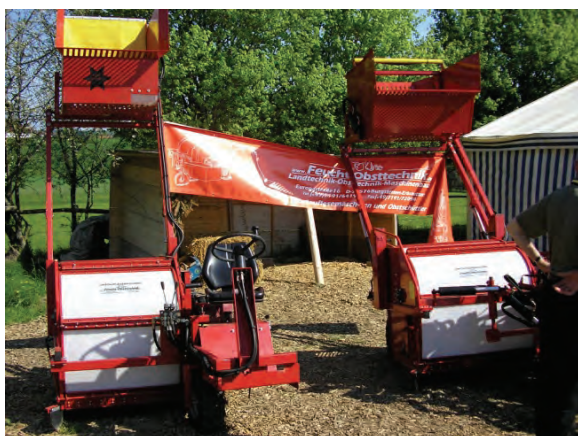
Die Obstauflesemaschinen OB 80 R (links) und OB 100 A mit Seitenräumer (rechts) von Feucht
