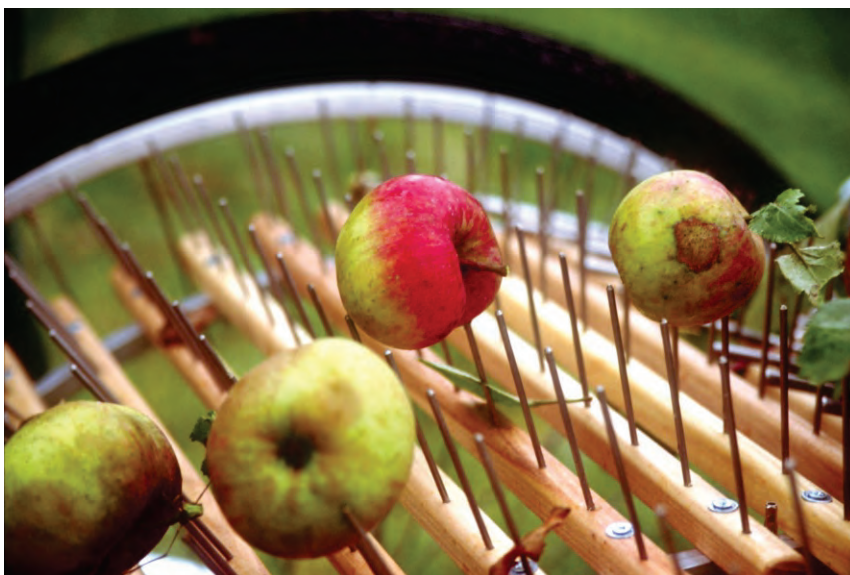
Die Äpfel werden beim Obstigel® HWO - 01 auf Edelstahlstifte aufgespießt – eine schnelle Verarbeitung ist unerlässlich
