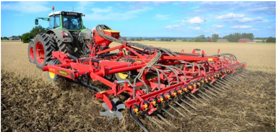
Abb. 11: In der Praxis setzen sich zunehmend sogenannte Grubbersaaten durch. Dabei wird ein Pneumatikstreuer auf einen Grubber oder eine Scheibenegge aufgesattelt. Das Saatgut wird über breit streuende Säaggregate bzw. Säschläuche in den Bodenstrom meist vor oder in die nachlaufende Packerwalze gleichmäßig über die Arbeitsbreite verteilt.
